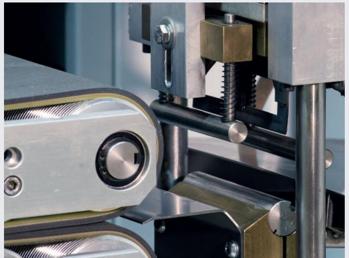
Die MBS kann mit verschiedenen Werkzeugen bestückt werden. Hier im Bild das Heißschneidmodul
