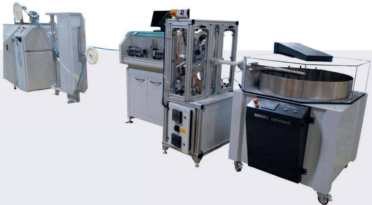
Für nachgelagerte Prozesse müssen Kabel oft gereinigt werden. Dabei muss entweder Talkum aus der Kabelherstellung oder Oberflächenschmutz entfernt werden. Diese Aufgabe meistert die Metzner Inline-Kabelreinigungsstation erfolgreich.
