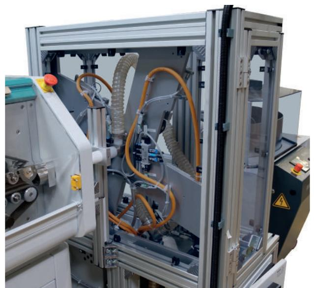
Kabelreinigungseinheit mit Bürsten
